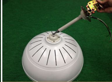
(b)パイプ差し込み
