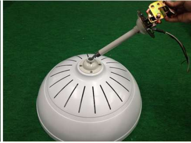
(b)パイプ差し込み
